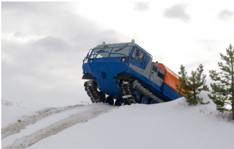
ТМ-140 преодолевает подъемы крутизной до 30^{\circ}
